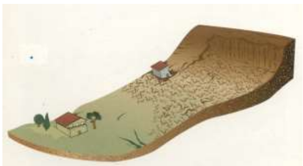
Figura 7 – Possibilidade de deslizamentos de vertente.
