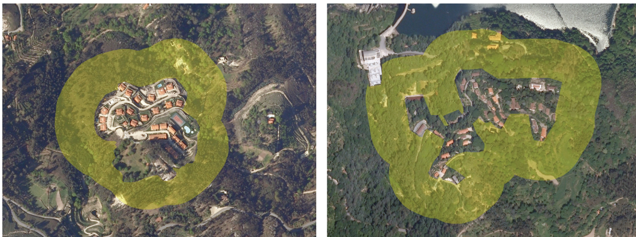
Imagem 1 – Aglomerados prioritários em Zona de Interface Urbano Florestal (ZIU) com necessidade de faixa de gestão de combustível de protecção, sitos nas freguesias de Caniçada e de Salamonde
